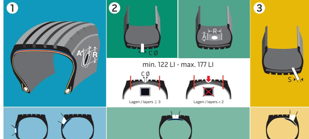
Dies ist eine international gültige Reparaturtabelle für die Anwendung von REMA TIP TOP Reparaturmaterialien und -systemen. Die angegebenen Schadensgrößen werden basierend auf Erkenntnissen der Praxis, Prüfstandskontrollen und -tests in Erfahrungsrichtwerten unter Anwendung der REMA TIP TOP Reparatussysteme festgelegt.
