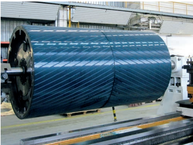
Trommelbeschichtung mit Polyurethan
